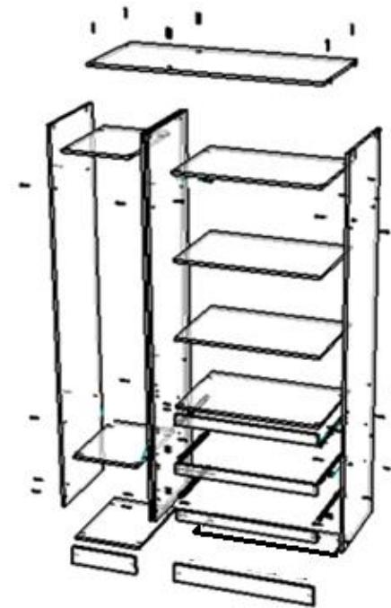
Ввернуть шток эксцентрика в деталь 14. Шурупами 4\*45 скрепить детали 10 и 11. Детали 10 и 14 скрепить замком эксцентрика. Вставить ЛДВП 16 в пропил фасада и прибить гвоздями к деталям 10 и 11 предварительно измерив диагональ. Шурупами 3,5\*16 привернуть направляющие к детали 10 колесиком назад как показано на рисунке. Установить ящики на направляющие привернутые к боковинам. Шурупами 3,5\*16 привернуть скалка держатели к детали 1 в намеченные отверстия и установить скалку.
