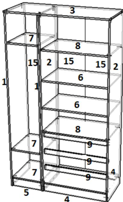
Шурупами 3,5\*16 привернуть в наметки, направляющие к детали 2 колесиком вперед. Прибить гвоздями подпятники к боковине 1 и 2. Вставить шкант 8\*30 в отверстия детали 2. Евровинтами скрепить детали 1, 5 и 7; 2, 4 и 8 предварительно установив планки 6 на шканты. Соединить межсекционными стяжками детали 1 и 2(пенала и шкафа в зависимости от какой стороны будет пенал). Евровинтами скрепить детали 1, 2 и 3. Прибить ЛДВП (используя соединительный брус) к тыльной стороне каркаса
