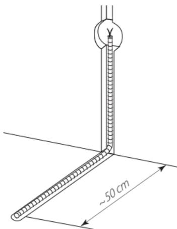
Датчик температуры пола устанавливается в монтажной трубке, в полу, на расстоянии 50 см от стены, на которой расположен терморегулятор. Трубка с датчиком внутри должна располагаться на равном расстоянии между витками кабеля для наиболее точного измерения температуры.
