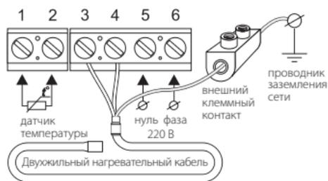
Схема подключения к 3-х проводной электрической сети
