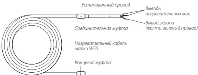
Конструкция кабеля нагревательного WSS
