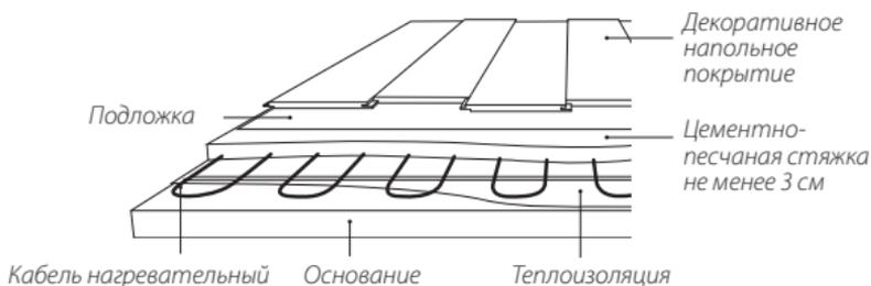
Схема укладки под ламинат, линолеум или ковролин
