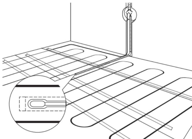
лучшего сцепления стяжки с основанием. Вырезы должны располагаться в шахматном порядке между витками кабеля нагревательного. При применении наливного пола вырезы в теплоизоляции не нужны.
