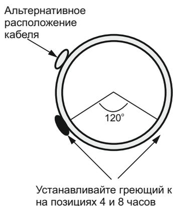
Рис.4 Установка кабеля вдоль трубы
