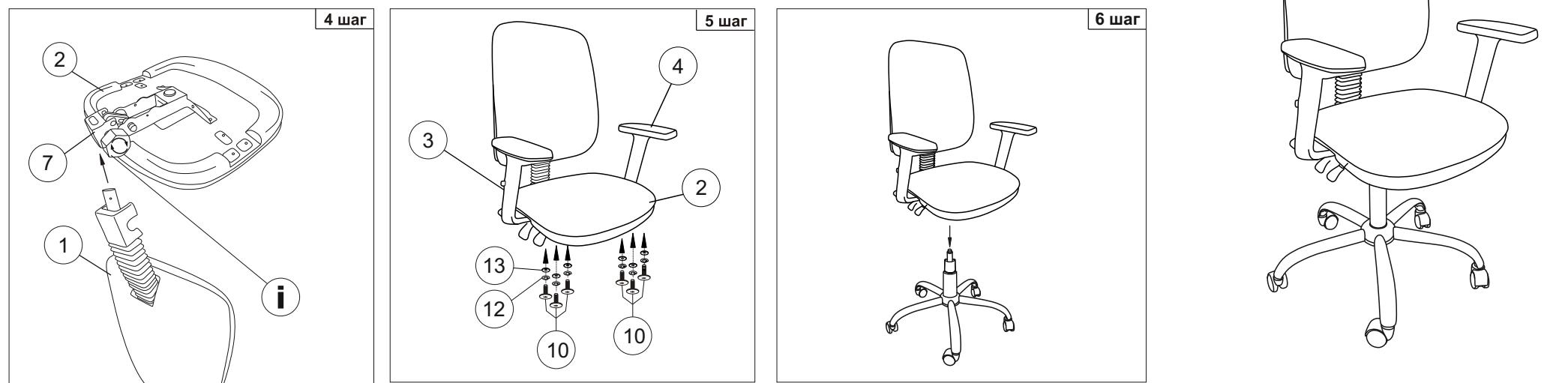
**Затянуть гайку-барашек для фиксации спинки. (Шаг 4)**
