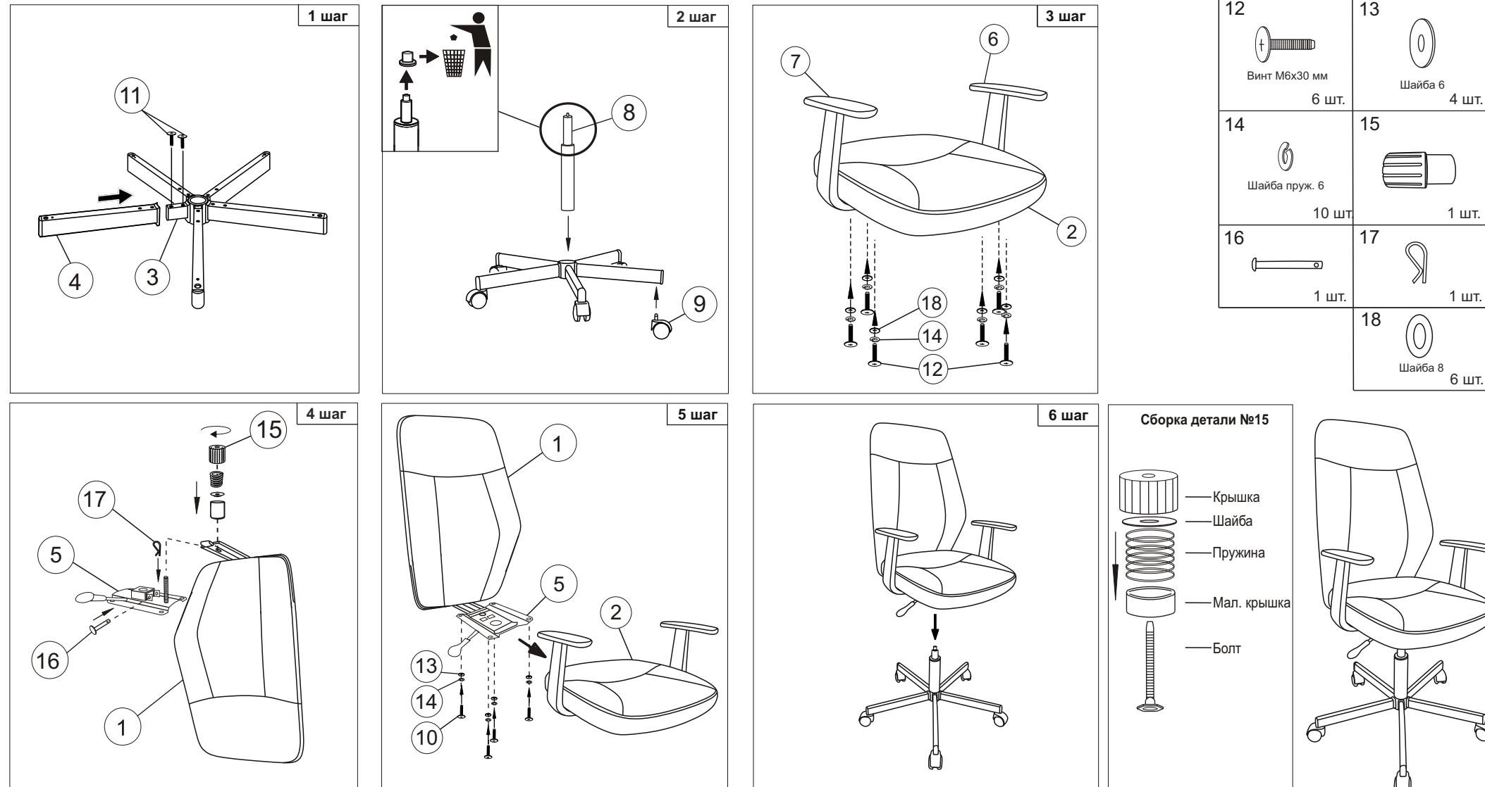
Примечания: Шаг 2. Снять защитный колпачок с газлифта, в случае его наличия.
